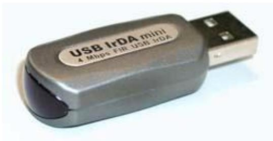
Drahtlose Verbindung von PC mit Infrarotgeräten
